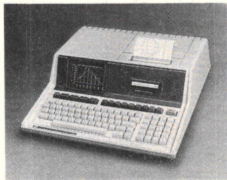
Afb. 1. Het compacte computersysteem heeft naast een overzichtelijk toetsenbord, een ingebouwde cassette-recorder, een thermische printer en een 13 cm beeldscherm.
